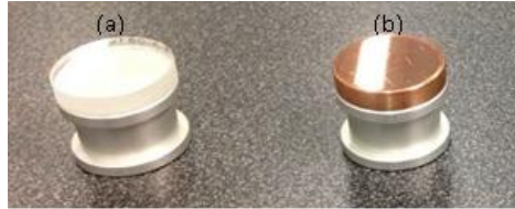
Figure 9: Matériaux testés; (a) silice fondue ( fused silica ) et (b) Cuivre.
