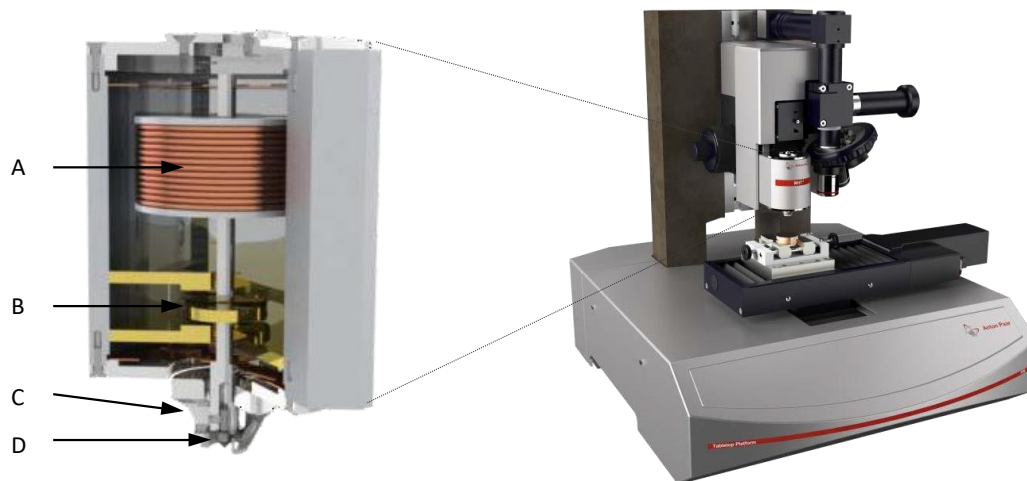
Figure 7: Un système de nanoindentation commercial avec une découpe de sa tête de mesure. Un électro aimant (A) applique une force sur la tige de l'indenteur et le capteur capacitif (B) mesure le déplacement résultant. La pointe de l'indenteur (D) se déplace par rapport à l'anneau de référence (C) qui repose sur la surface de l'échantillon (Anton Paar TriTec SA).
